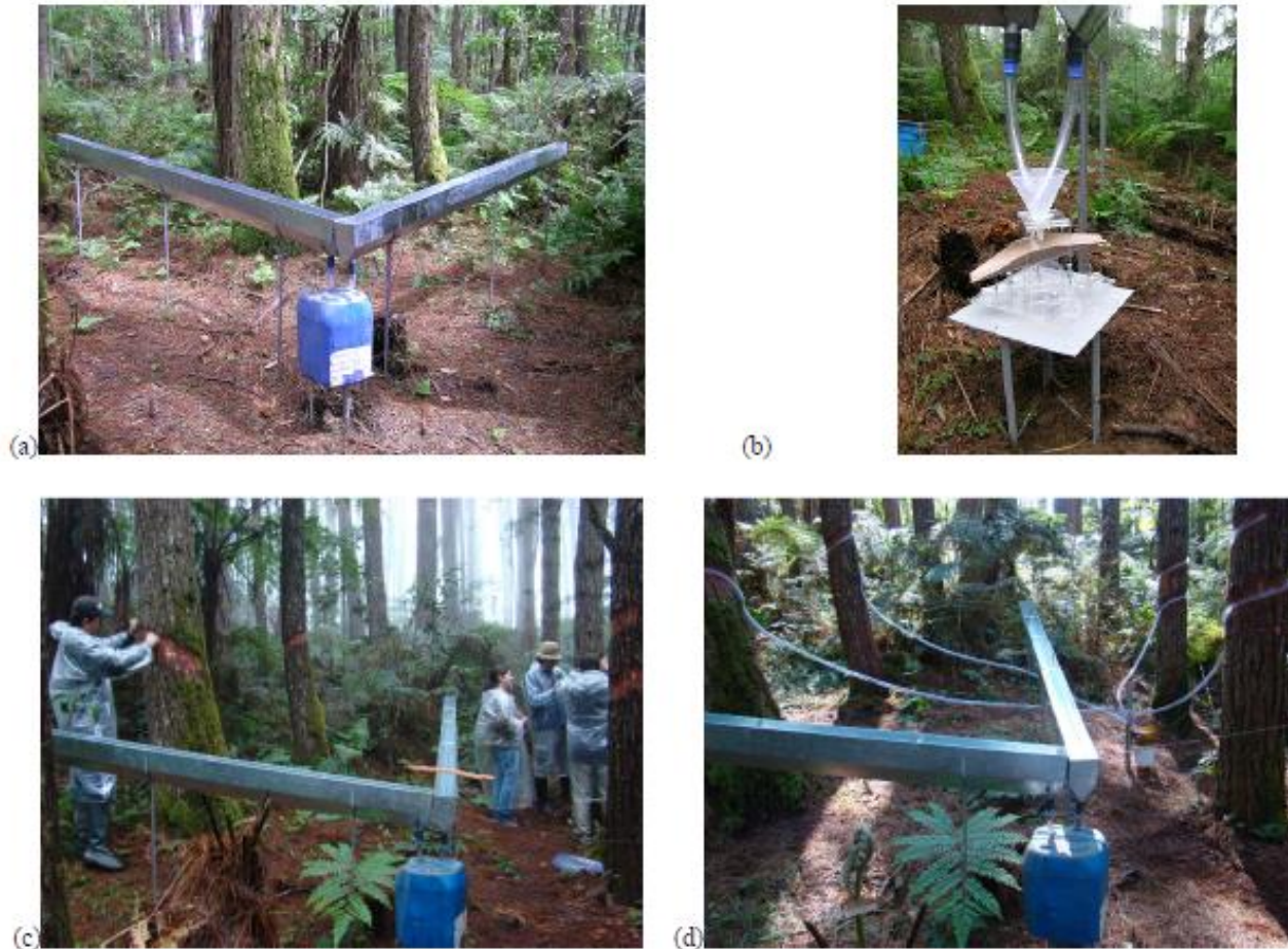
Figura 5.4. (a) Instalação de calha para coleta de chuva interna. (b) Detalhe de mangueiras que ligam a calha ao pluviôgrafo do tipo báscula. (c) Limpeza da casca para instalação de mangueiras de coleta de escoamento de tronco. (d) Área com medição instalada de chuva interna e escoamento de tronco.
